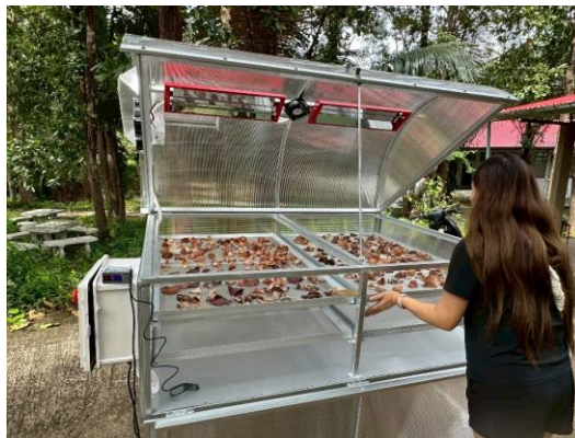
ภาพที่ 4 แสดงกระบวนการจัดชุดการทดลองของกลุ่มทดลองที่อบเห็ดหูหนูในตู้อบพลังงานแสงอาทิตย์
