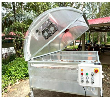
ภาพที่ 2 การติดตั้งแผงโซลาร์เซลล์ และพัดลมระบายความชื้นด้านข้างตัวตู้
