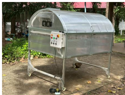
ภาพที่ 5 ตู้อบเห็ดหูหนูพลังงานแสงอาทิตย์ต้นแบบที่สร้างเสร็จสมบูรณ์
