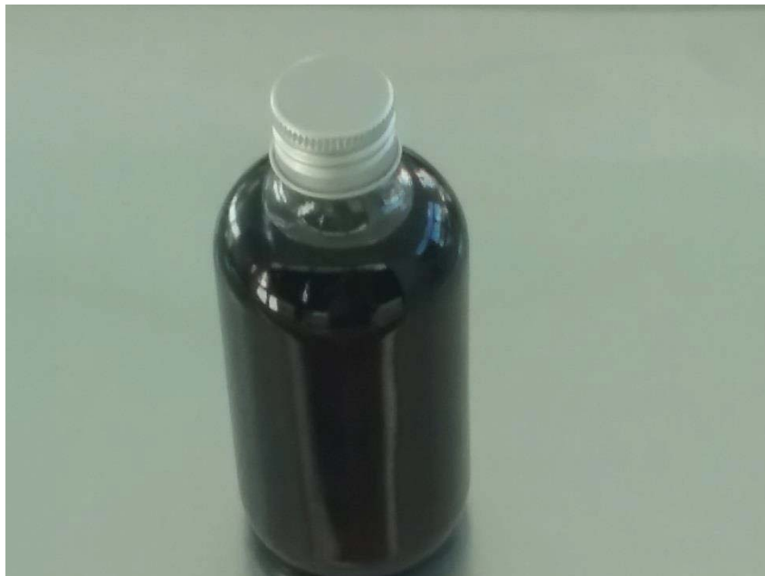
ภาพที่ 5 ลักษณะน้ำมันไพโรไลซิสที่สกัดจากพลาสติกชนิด PS ที่มีสีน้ำตาลเข้ม
