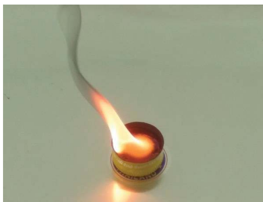
ภาพที่ 6 ลักษณะเปลวไฟจากการเผาไหม้ของน้ำมันไพโรไลซิสที่สกัดจากพลาสติกชนิด PS
