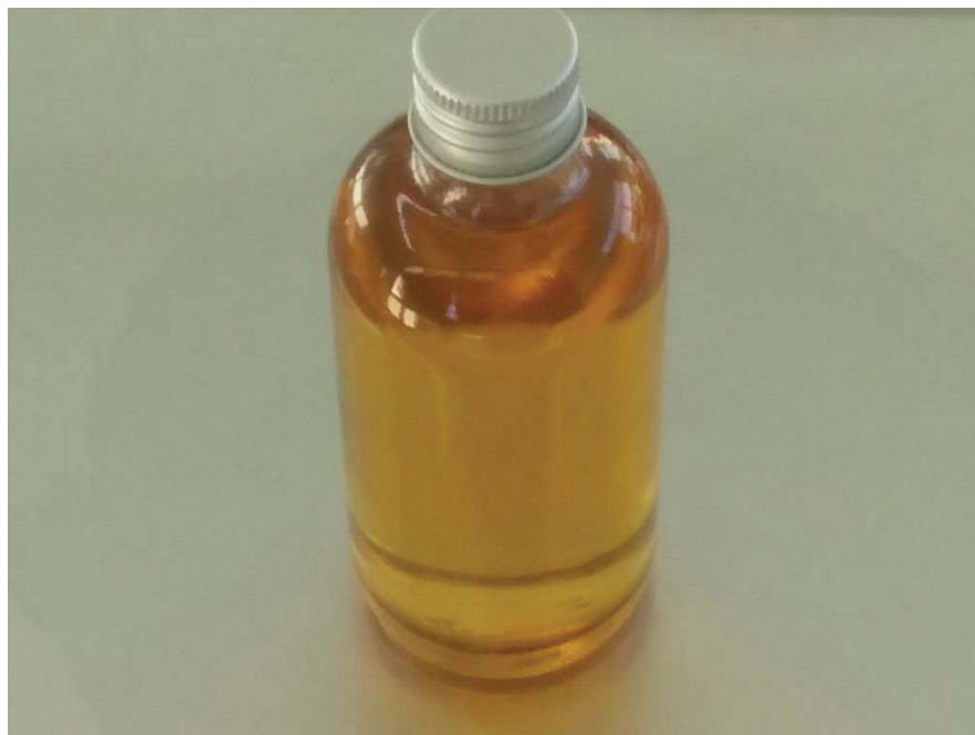
ภาพที่ 3 ลักษณะน้ำมันโพลีโพรพิลีนที่สกัดจากพลาสติกชนิด PP ที่มีสีเหลืองอำพัน
