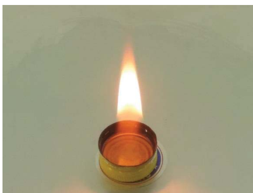
ภาพที่ 4 ลักษณะเปลวไฟจากการเผาไหม้ของน้ำมันโพลีโพรพิลีนที่สกัดจากพลาสติกชนิด PP
