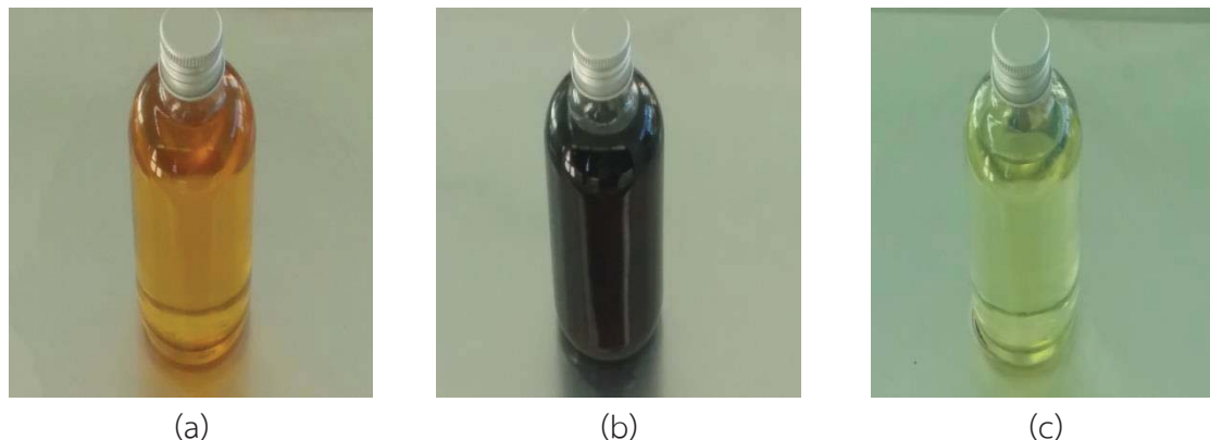
ภาพที่ 4.7 ลักษณะของสีของน้ำมันโพลีโอสติส (a) น้ำมันโพลีโอสติสจากพลาสติก ชนิด PP (b) น้ำมันโพลีโอสติสจากโพลี ชนิด PS และ (c) น้ำมันก๊าด
