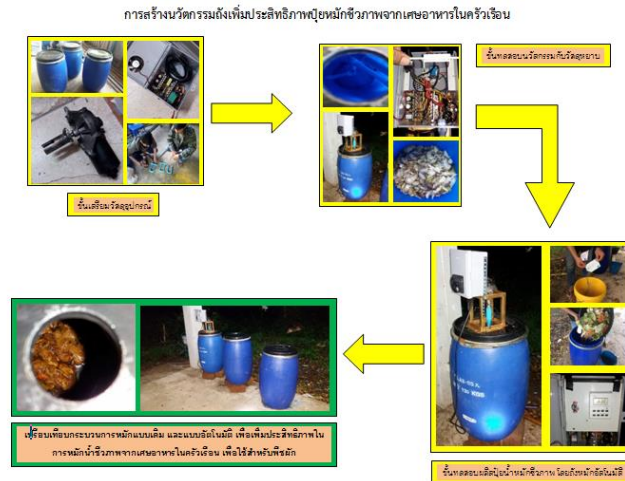
ภาพที่ 6 แสดงขั้นตอนในการทดสอบกำลังของถังหมักปุ๋ยอัตโนมัติ และขั้นตอนในการหมักปุ๋ยน้ำชีวภาพระบบอัตโนมัติ เปรียบเทียบกับกระบวนการหมักแบบเดิมตามวิธีของเกษตรกร
