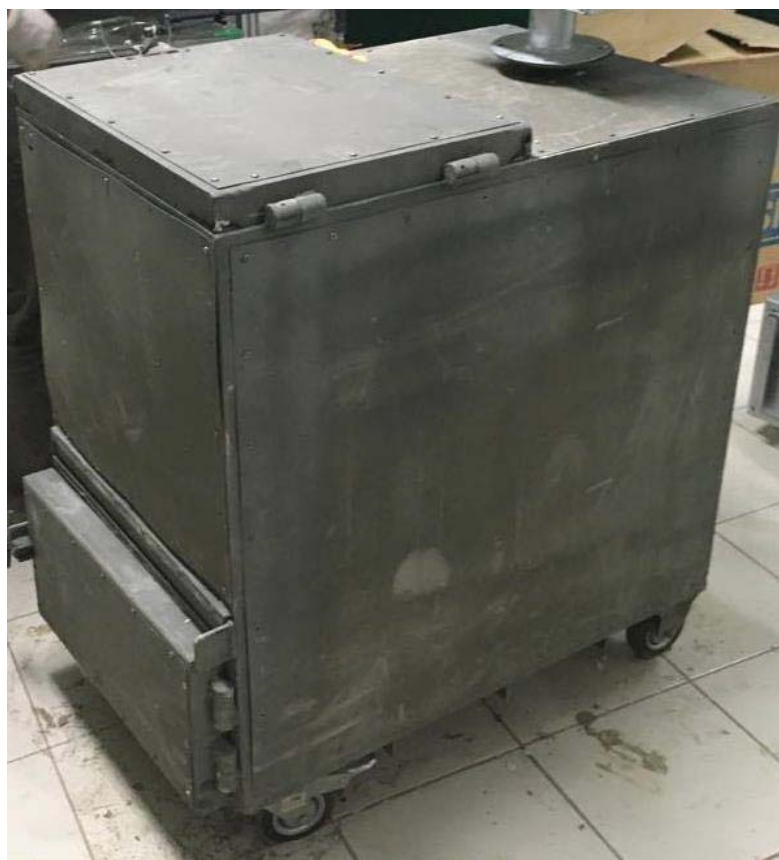
รูปที่ 4.12 เตาเผาขยะมูลฝอยติดเชื้อระดับชุมชนที่ได้จัดสร้างขึ้น
