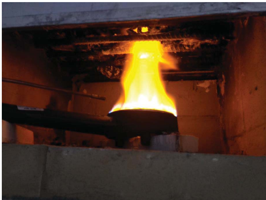
รูปที่ 4.25 การใช้หัวจ่ายแก๊สสนามโดยใช้เชื้อเพลิงคือก๊าซหุงต้มเป็นแหล่งให้ความร้อนแก่เตาเผา
