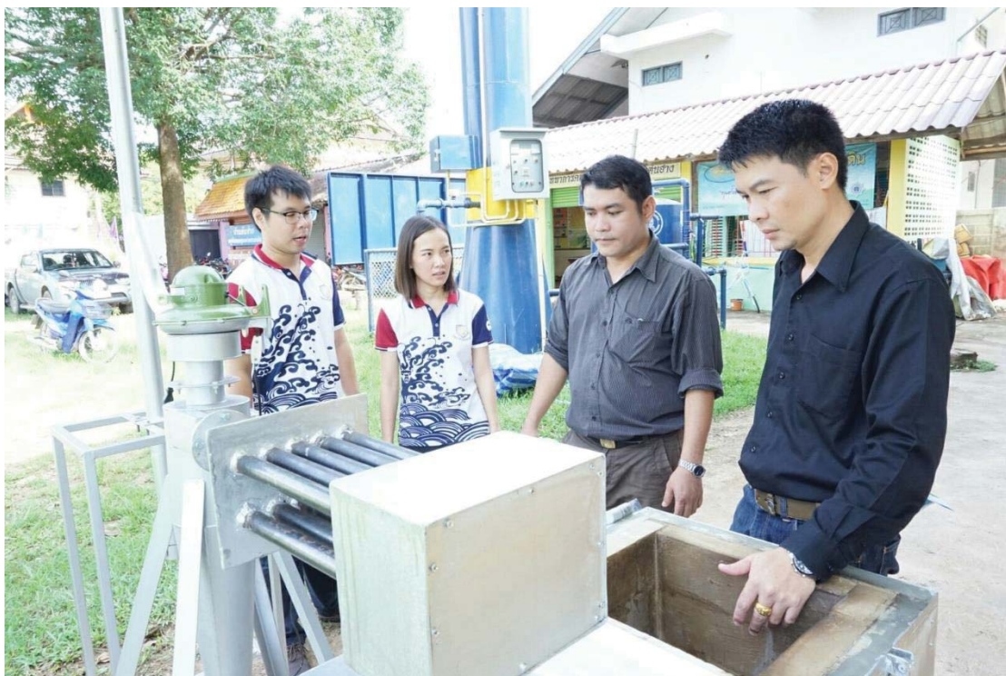
รูปที่ 4.8 การสาธิตการทำงานของระบบบำบัดก๊าซไอเสียเมื่อต่อร่วมกับเตาเผาขยะติดเชื้อชุมชน
