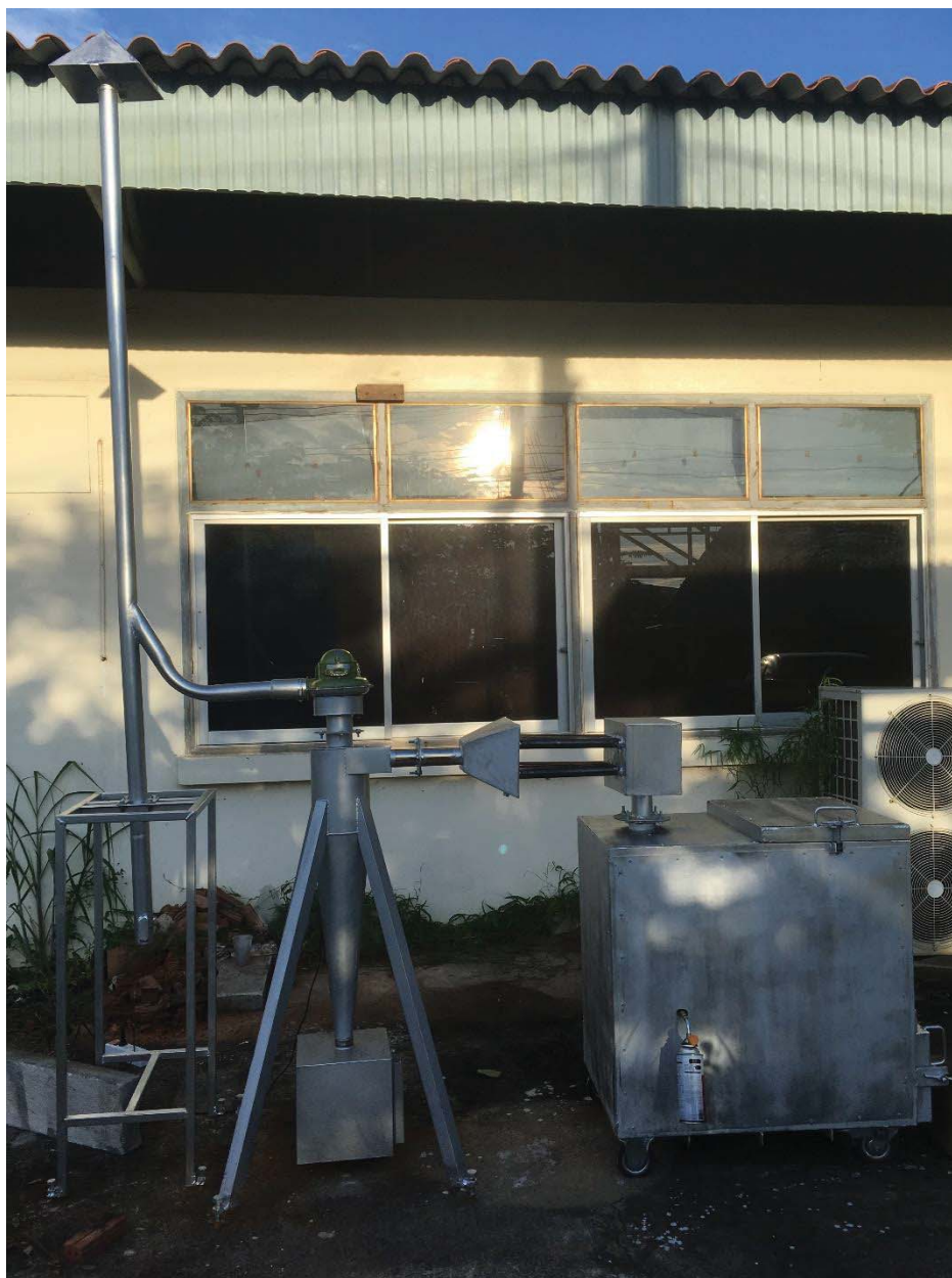
รูปที่ 4.6 ลักษณะภาพรวมของระบบบำบัดก๊าซพิษจากเตาเผาขยะ
