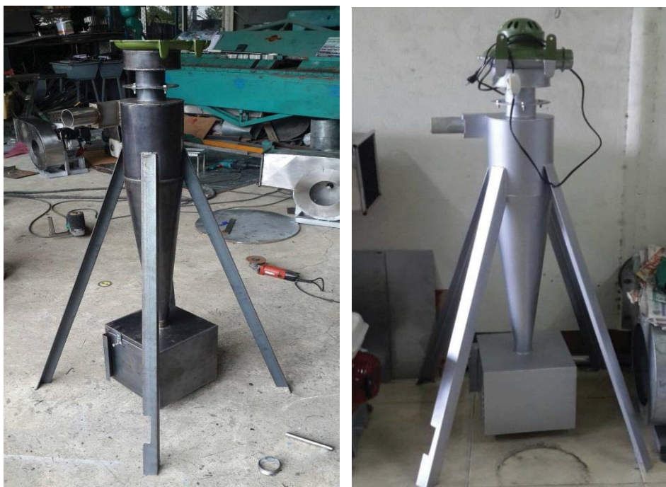
รูปที่ 4.4 ลักษณะของไซโคลน
