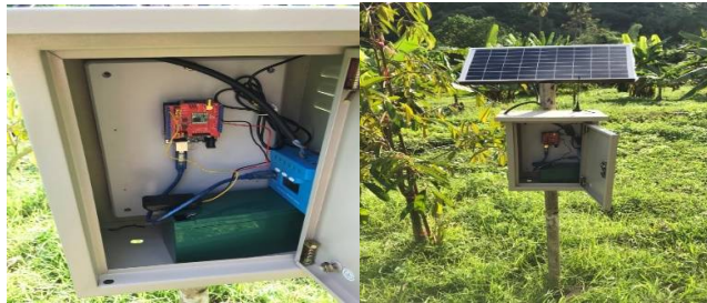
ภาพที่ 4.43 อุปกรณ์เพื่อตรวจวัดค่าสภาพแวดล้อมต่าง ๆ สำหรับสถานีย่อย (Sensor node)
