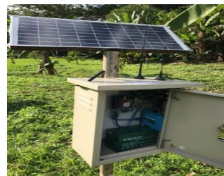
ภาพที่ 4.46 อุปกรณ์ควบคุมของสถานีควบคุม (Gateway) ทำหน้าที่ส่งต่อข้อมูลจากสถานีย่อยต่าง ๆ นำไปจัดเก็บบนระบบฐานข้อมูล
