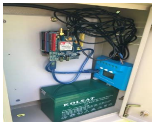
ภาพที่ 4.46 อุปกรณ์ควบคุมของสถานีควบคุม (Gateway) ทำหน้าที่ส่งต่อข้อมูลจากสถานีย่อยต่าง ๆ นำไปจัดเก็บบนระบบฐานข้อมูล
