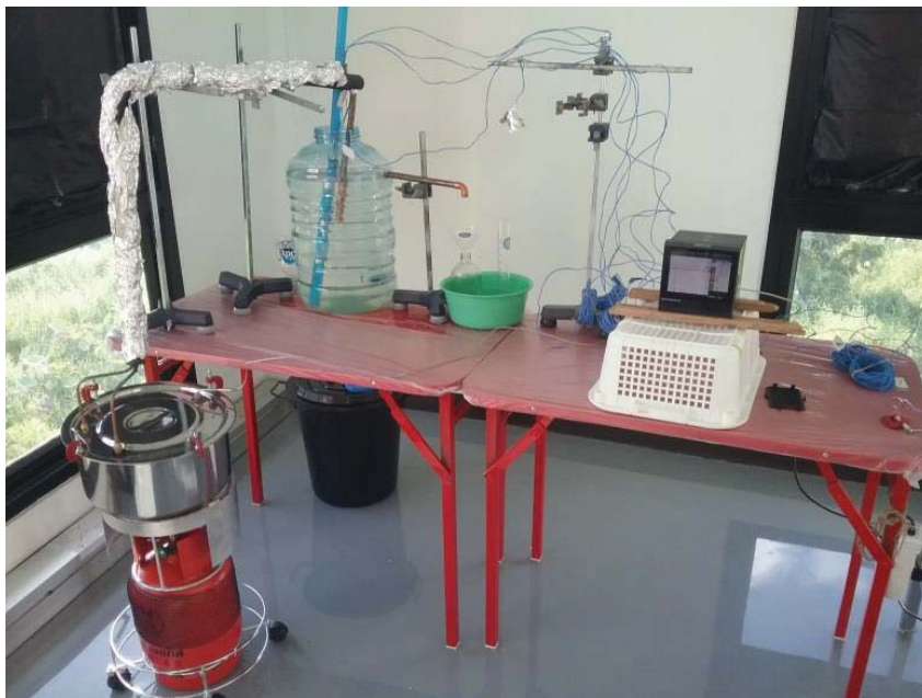
ภาพที่ 3.8 ระบบไฟโรไลซ์อย่างง่าย ที่ต่อสายวัดอุณหภูมิและเก็บผลข้อมูลด้วยเครื่องบันทึกข้อมูล data logger รุ่น MT100
