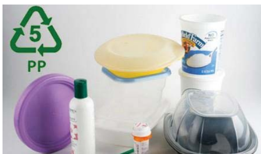
ภาพที่ 2.3 ผลิตภัณฑ์พลาสติกประเภทพอลิโพรไพลีน (Polypropylene: PP) (foodnetworksolution, 2560. ออนไลน์)
