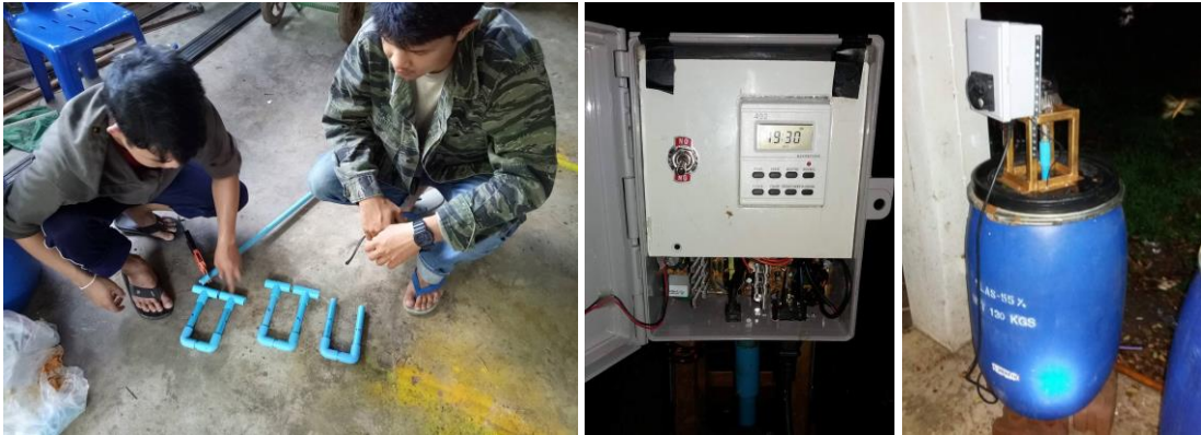
ภาพที่ 3 แสดงการออกแบบใบกวน(ซ้าย) แสดงระบบควบคุมอัตโนมัติ (กลาง) และ ลักษณะถังหมักปุ๋ยน้ำชีวภาพระบบอัตโนมัติ (ขวา)
