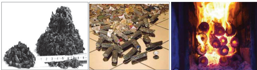
ภาพที่ 12 การนำขยะที่เผาได้ไปบดและอัดเป็นแท่งเชื้อเพลิง RDF ก่อนนำไปใช้เป็นเชื้อเพลิงในการเผาไหม้ (สัญญาชัย ชนะสงคราม, 2559: 3)
