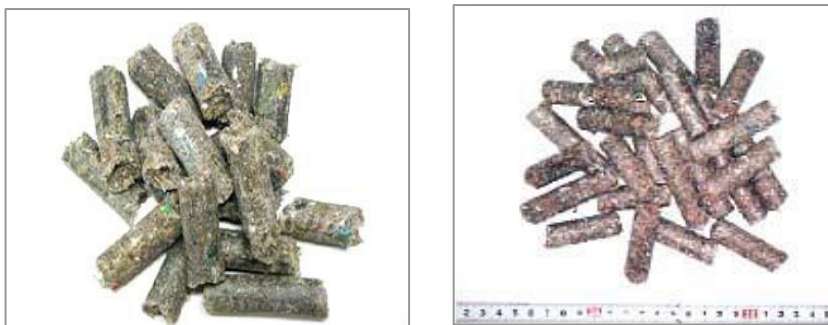
ภาพที่ 13 แท่งเชื้อเพลิงขยะ Densified RDF หรือ RDF5 หรือเรียกว่า d-RDF (สัจชัย ชนะสงคราม, 2559: 5)
