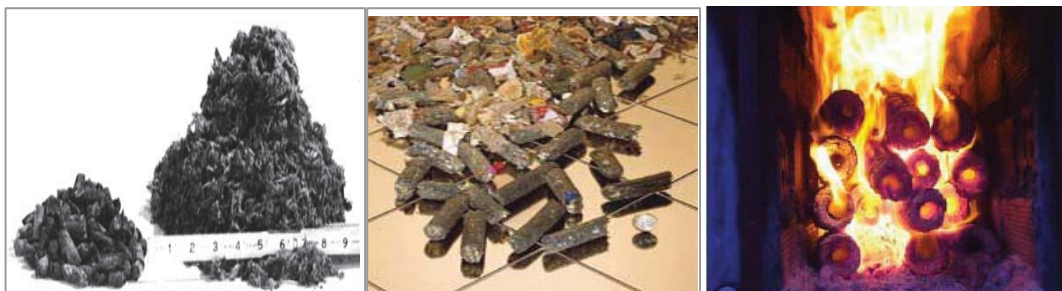
ภาพที่ 12 การนำขยะที่เผาได้ไปบดและอัดเป็นแท่งเชื้อเพลิง RDF ก่อนนำไปใช้เป็นเชื้อเพลิงในการเผาไหม้ (สัญญา ชนะสงคราม, 2559: 3)
