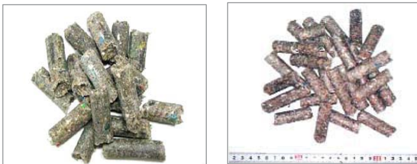
ภาพที่ 13 แท่งเชื้อเพลิงขยะ Densified RDF หรือ RDF5 หรือเรียกว่า d-RDF (สัณชัย ชนะสงคราม, 2559: 5)
