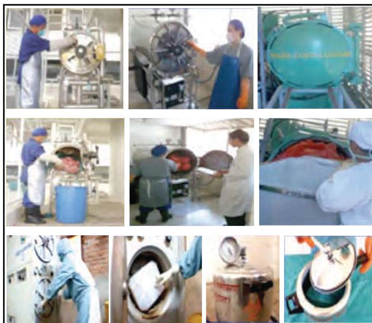
รูปที่ 2.3 การอบไอน้ำหรือการนึ่งที่เพื่อทำลายเชื้อในมูลฝอยติดเชื้อ
