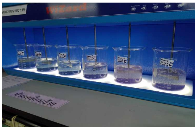
ภาพที่ 4.2 การกวนผสมระหว่างสารสัมผัสคลอรีนในอัตราส่วน 7:1, 6:1, 5 1, 4:1, 3:1 และ 2:1 (กรัมต่อกรัมต่อน้ำเสีย 1 ลิตร)
