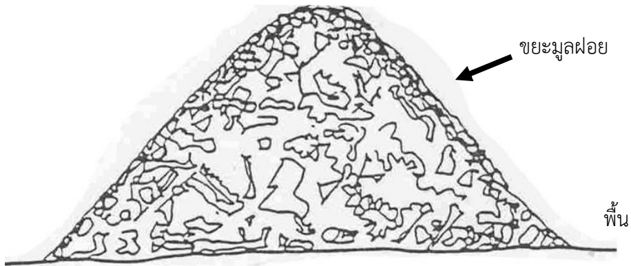
รูปที่ 3-1 ลักษณะการกองขยะให้เป็นรูปกรวยก่อนที่จะแบ่งขยะออกเป็น 4 ส่วน ที่มา : เสรีย์ ตู้อุประภาย, 2556 (อ้างถึงในพันชัย เม่นฉาย และคณะ, 2557)
