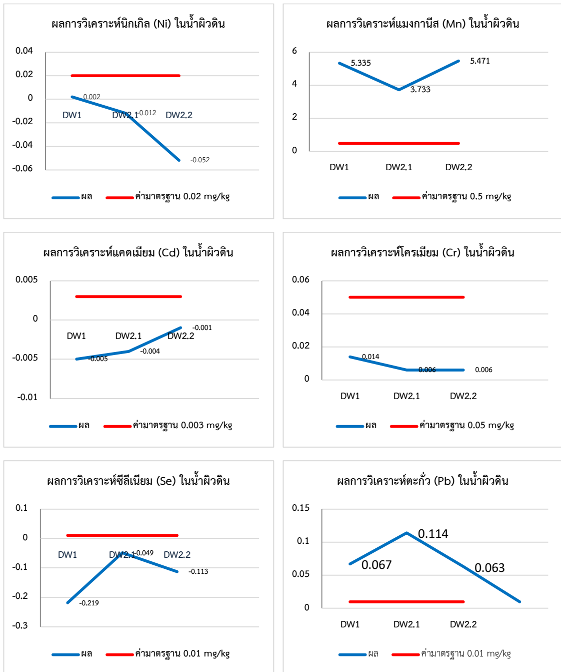
ภาพที่ 4.3 กราฟแสดงค่าวิเคราะห์ปริมาณโลหะหนักในน้ำที่ใช้ทำนาข้าว บริเวณพื้นที่องค์การบริหารส่วนตำบลดงมะไฟ อำเภอเมืองสกลนคร จังหวัดสกลนคร
