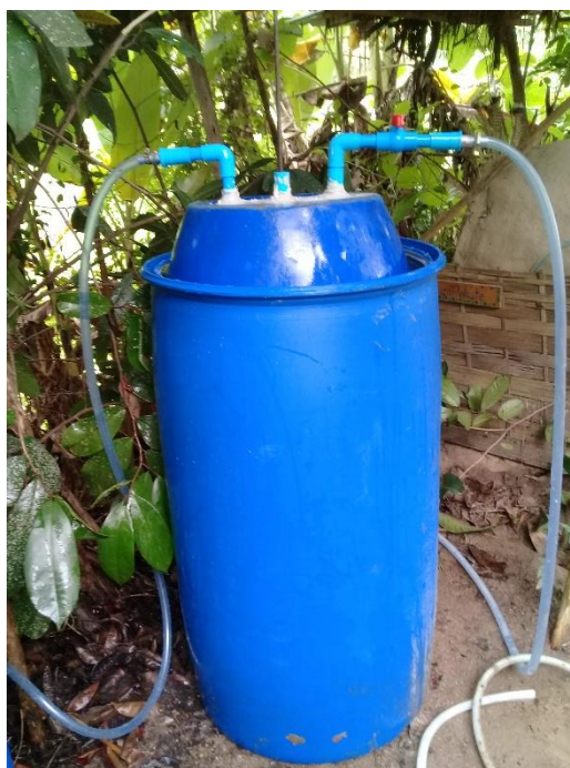
ภาพที่ 3-4 ถังเก็บแก๊ส (ชุดการทดลองที่สร้างขึ้น)
