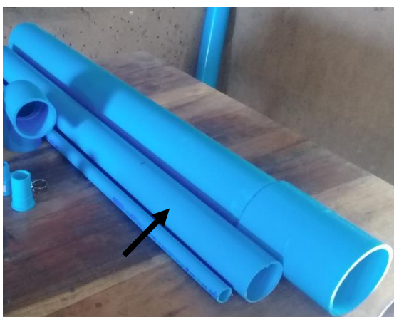
ภาพที่ 3-10 ท่อขนาด 2 นิ้ว ยาว 35 เซนติเมตร
