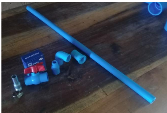
ภาพที่ 3-8 อุปกรณ์ที่ใช้ในการทำท่อส่งแก๊ส
