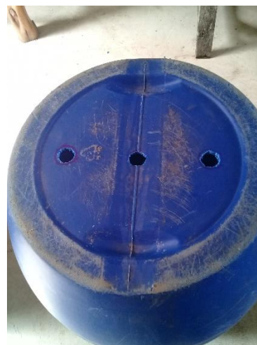
ภาพที่ 3-18 เจาะรูที่ก้นถัง 3 รู ขนาดท่อ 4 นิ้ว
