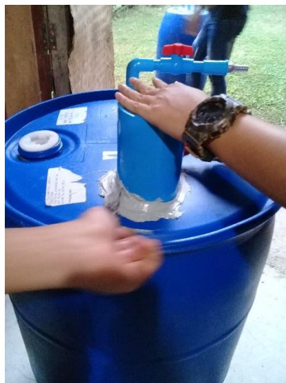
ภาพที่ 3-24 ทากาวอีปส์ล็อกซีซูด AB บริเวณรอบท่อ
