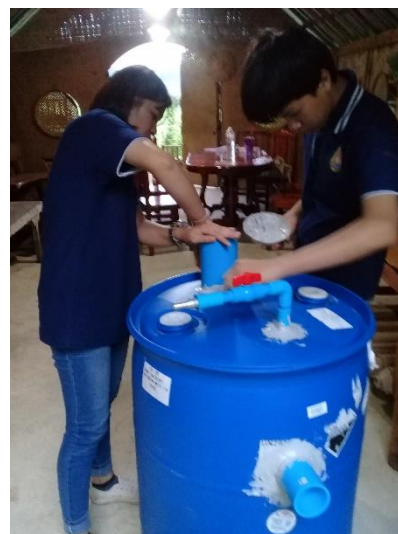
ภาพที่ 3-14 หลังจากต่อท่อเรียบร้อยแล้ว นำกากอึบสีคชี่ ชุด AB มาทา
