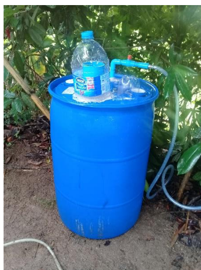
ภาพที่ 3-23 การต่อสายยางเข้ากับถังแก๊ส
