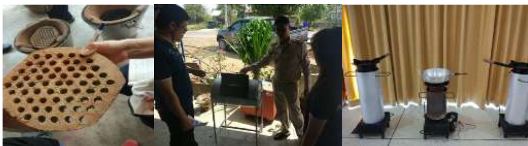
ภาพที่ 5 :เตาซูปเปอร์อั้งโล่ เตาย่างไร้ควัน และเตาแก๊สชีวมวล
